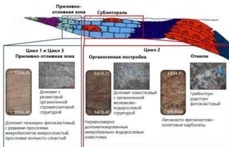
Рис. 1. Модель формирования карбонатных отложений осинского горизонта в Среднеботуобинском НКМ.
