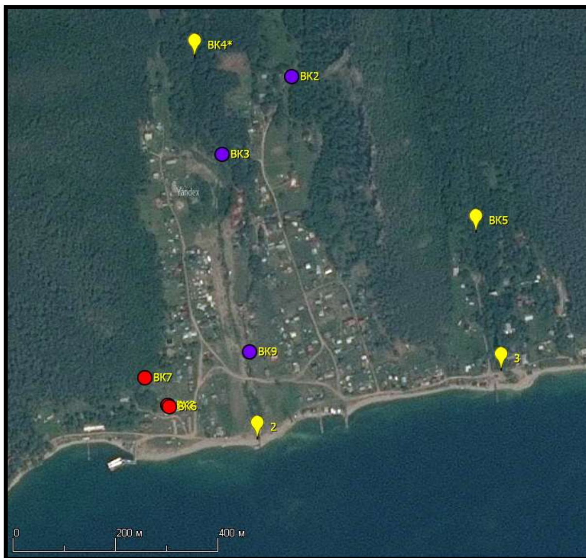
Рис. 2. Карта опробования водопунктов в п. Листвянка (верхняя панель) и космоснимок с указанием мест отбора проб в п. Большие Коты (нижняя панель). Желтые символы – вода из рек, сиреневые – из родников, красные – из скважин.
