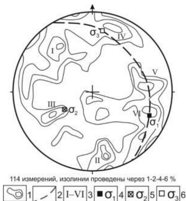
Рис. 27. Анализ тектонической трещиноватости в порфиридных гранитах приморского комплекса раннепротерозойского возраста в устье р. Черной. Сетка Вульфа.
