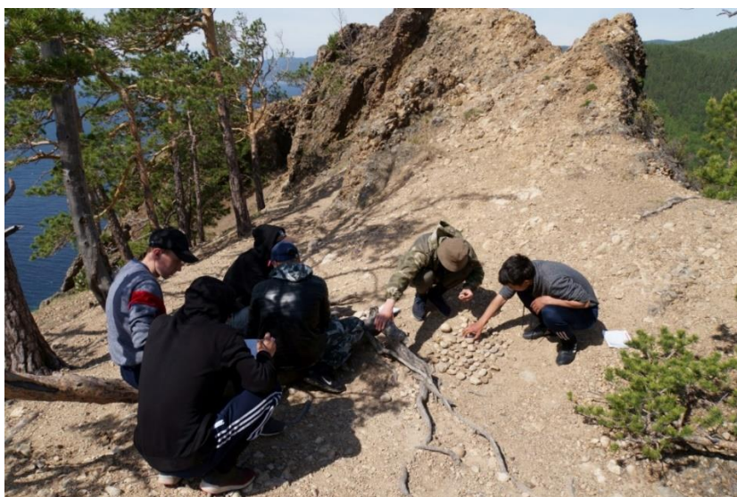
Рис. 15. Отбор статистической петрографической пробы галек из юрских конгломератов на г. Скрипер.
