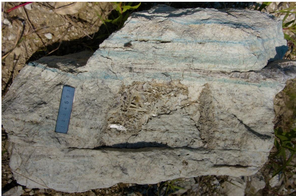
Рис. 12. Апатит-диопсид-кварц-кальцитовая порода с тремолитом Бурутуйского месторождения.
