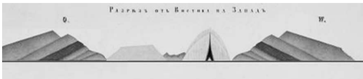
Рис. 4. Геологический разрез графитовой руды и окружающих гор. (Ботогольский голец (в центре) состоит из гранита, а обозначенная черным цветом рассекающая его жила – графит) (Фрагмент схемы из Альбома «Воспоминания о Сибири»).
