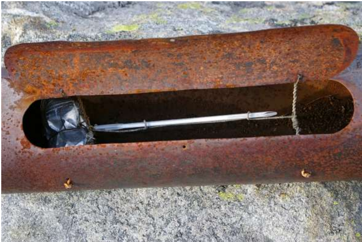
Рис. 3. Минимальный термометр С.П. Перетолчина в металлической капсуле сделанной еще в 1900 г. Fig. 3. Minimal thermometer of S.P. Peretolchin in a metal capsule made in 1900.
