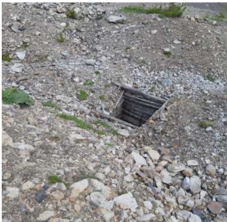
Рис. 11. Разведочный шурф. Фото 2021 г.
