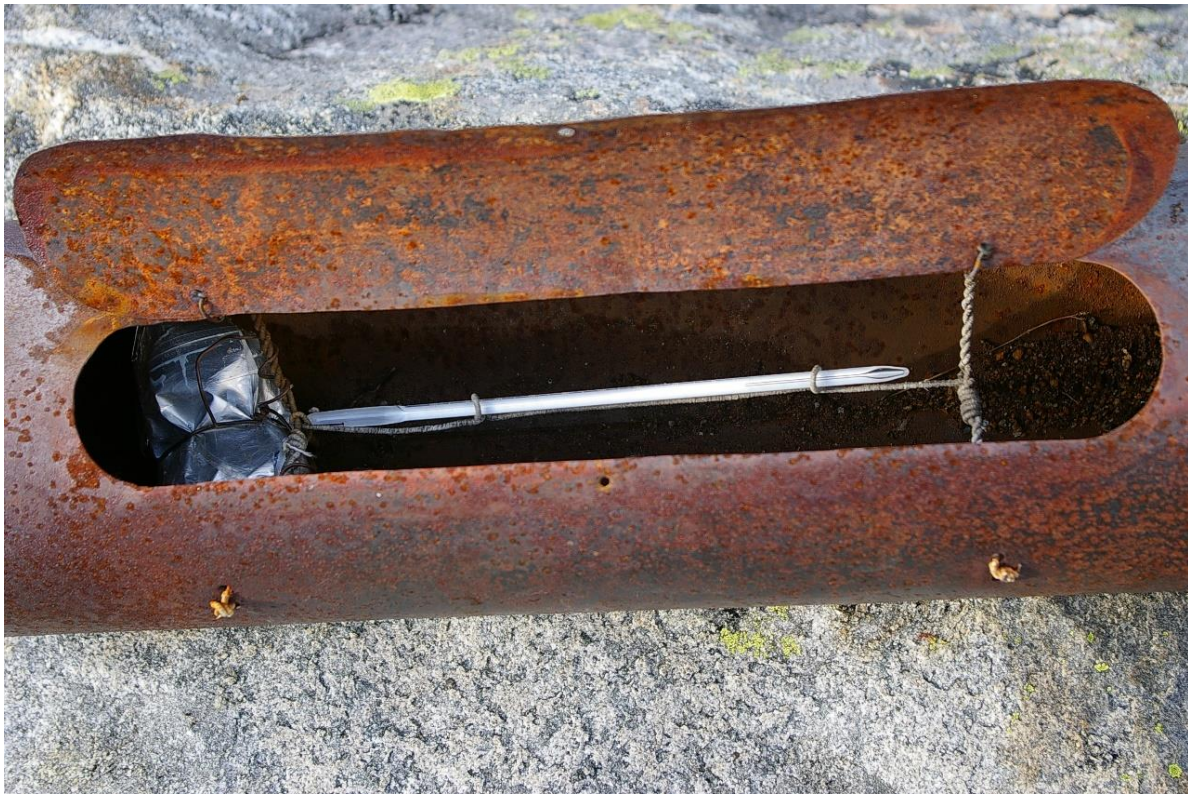
Рис. 3. Минимальный термометр С.П. Перетолчина в металлической капсуле сделанной еще в 1900 г.
