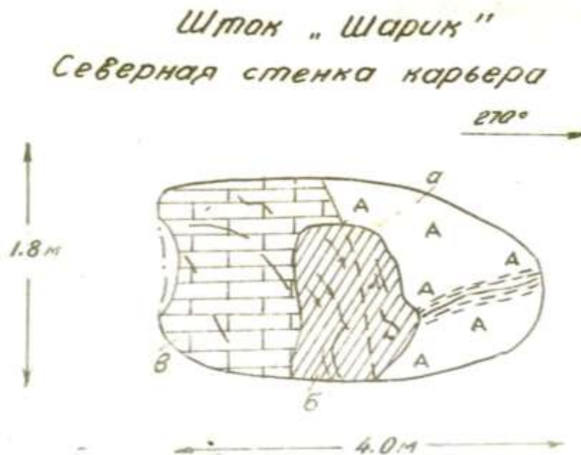
Рис. 5. Пример рудной залежи на контакте известняков и пироксеновых сиенитов: а – эпидото-диопсидовая порода, б – графит, в кристаллический известняк (Флоренсов и др., 1942).
