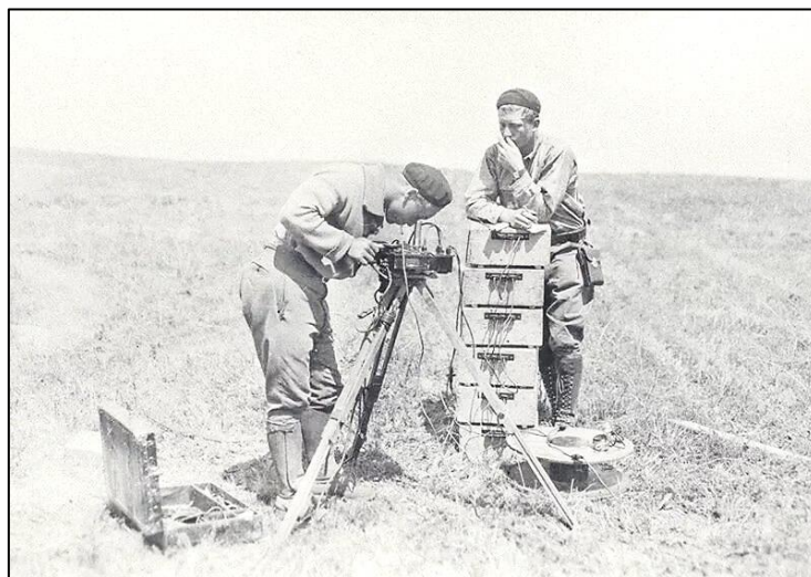
Рис. 9. Выполнение измерений методами сопротивлений. (Фото из свободного доступа в сети интернет).
