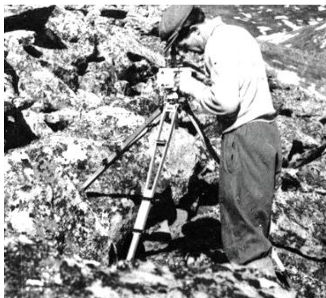
Рис. 8. Выполнение измерений магнитной индукции с помощью Z-магнитометра. (Фото из свободного доступа в сети интернет).
