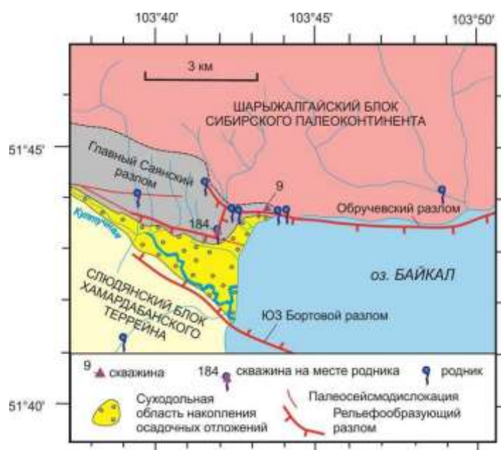
Рис. 1. Схема расположения мониторинговых скважин ст. 9 (Земляничная, КБЖД) и ст. 184 (Школьная) с установленными сенсорами для измерений ОВП, pH и температуры в режиме реального времени на западном побережье оз. Байкал (пос. Култук). Условия установки сенсоров охарактеризованы в работе (Рассказов и др., 2023).
