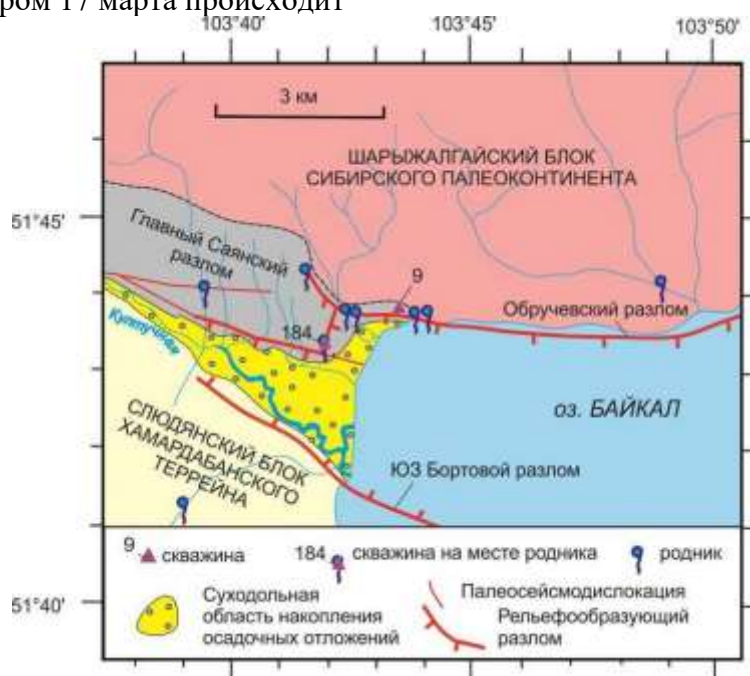
Рис. 2. Схема расположения мониторинговых скважин ст. 9 (Земляничная, КБЖД) и ст. 184 (Школьная) с установленными сенсорами для измерений ОВП, рН и температуры в режиме реального времени на западном побережье оз. Байкал (пос. Култук). Условия установки сенсоров охарактеризованы в работе (Рассказов и др., 2023).
