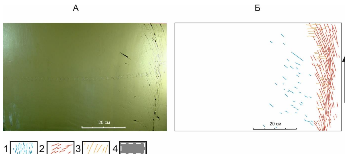
Рис. 5. Основные системы разрывных нарушений и площадь их пространственного распространения в модели при деформации сдвига в рамках второй серии экспериментов.
