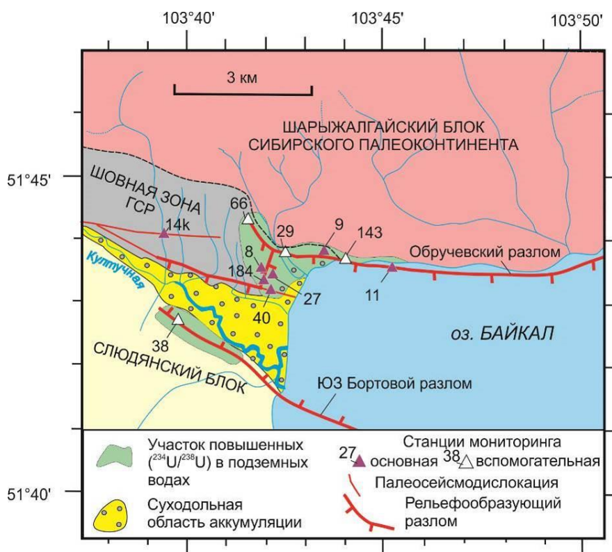
Рис. 2. Схема расположения ст. 27 и других основных и вспомогательных станций гидрогеохимического опробования активных разломов на западном побережье оз. Байкал (Култукский полигон). Палеосейсмодислокации в шовной зоне Главного Саянского разлома (ГСР) показаны по работе (Чипизубов, Смекалин, 1999).
