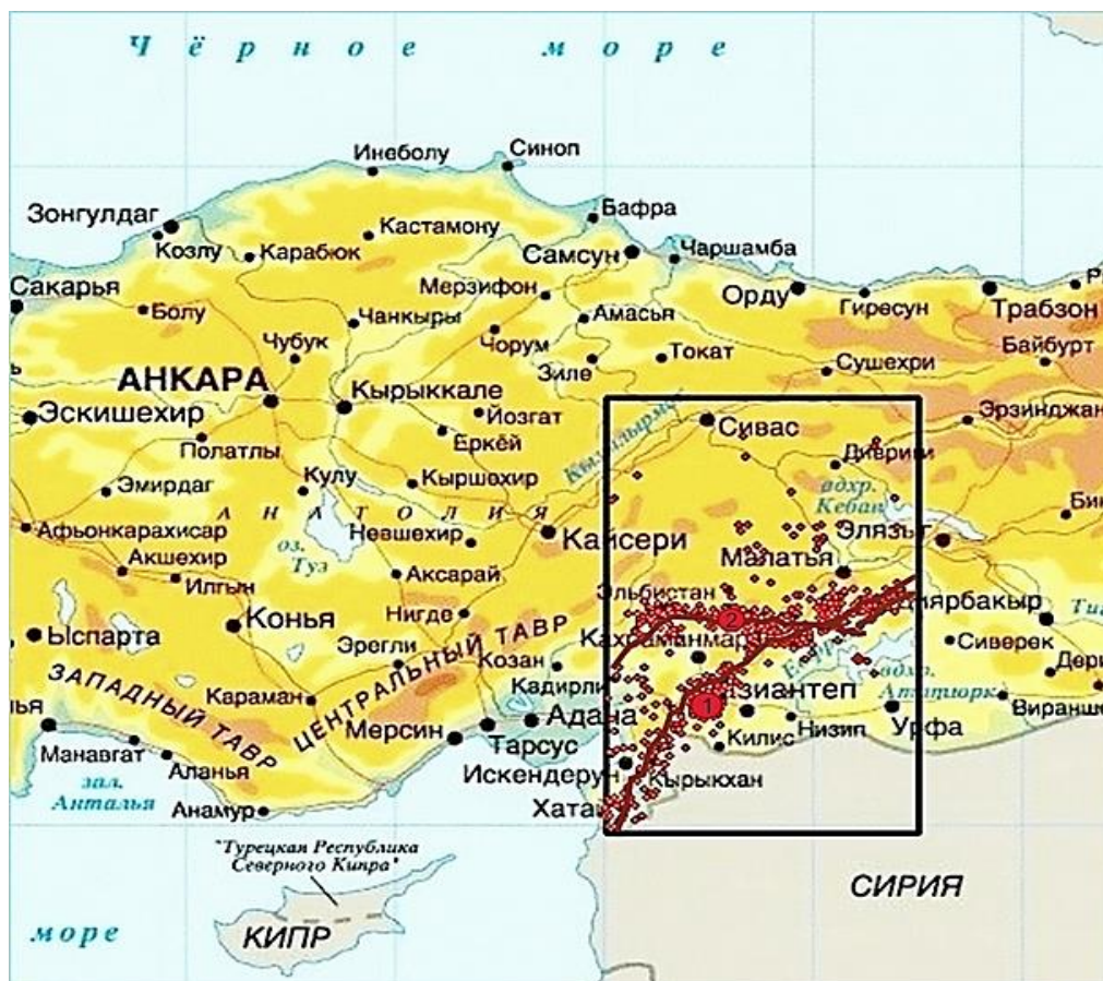
Рис. 1. Карта центральной части Турции, где черным прямоугольником обозначен район возникновения двух главных турецких землетрясений. Большими красными кружками отмечено положение эпицентров главных событий, а также форшоков и афтершоков с M \geq 4.0 , вместо, возникших за период наблюдений с 2013 года до 23.02.2013 гг.
